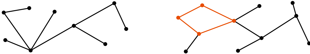
Abbildung 6.14: Der linke Graph ist ein Beispiel für einen Baum. Der rechte Graph ist kein Baum, weil er den farbig markierten Kreis enthält.
